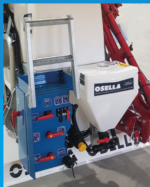
CHEMIESCHLEUSE UND BEDIENZENTRALE
