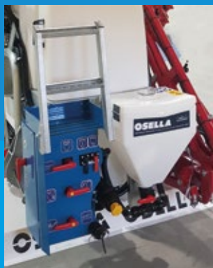
CHEMIESCHLEUSE UND BEDIENZENTRALE
